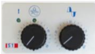
S1 РЕЗИСТОРНИЙ КОНТРОЛЕР ЗВАРЮВАННЯ ТІЛЬКИ ДЛЯ PN4-PN6
